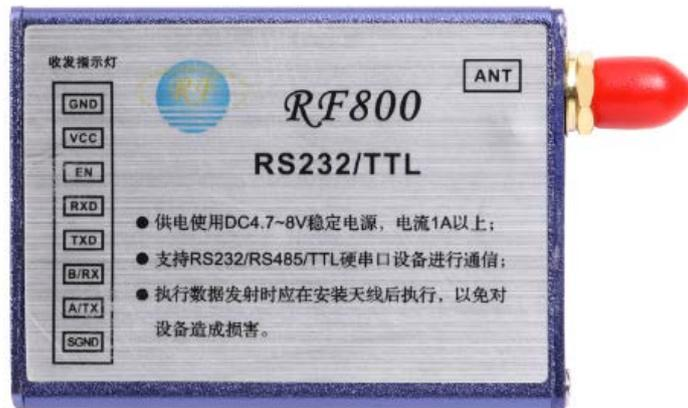
图 1: RF800 无线模块实物图
